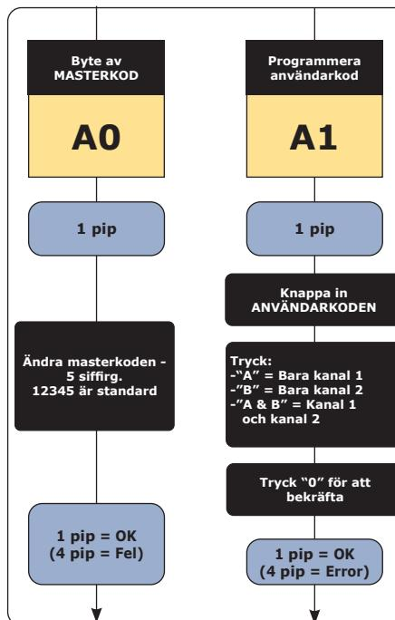
Felmeddelande uppkommer om masterkoden är samma som en användarkod
