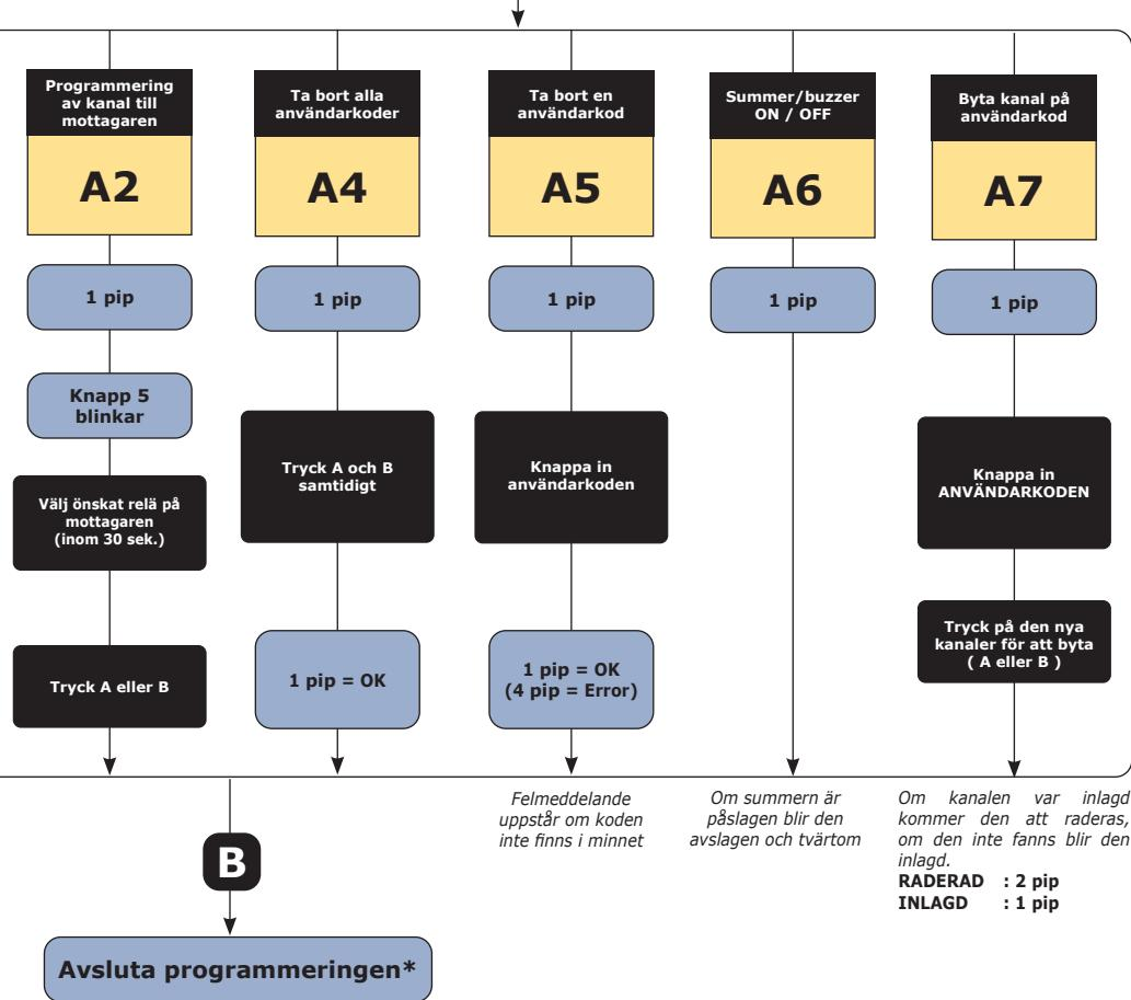
\* Programmeringen avbryts efter 10 sekunder om man inte rör knapparna
