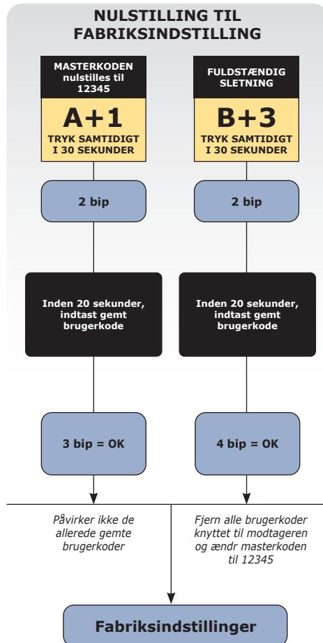
**NB.** "B+3"-proceduren sletter også den brugerkode, der er indtastet under proceduren. Tastaturet skal derfor sættes op til brugeren igen efter afsluttet procedure.
