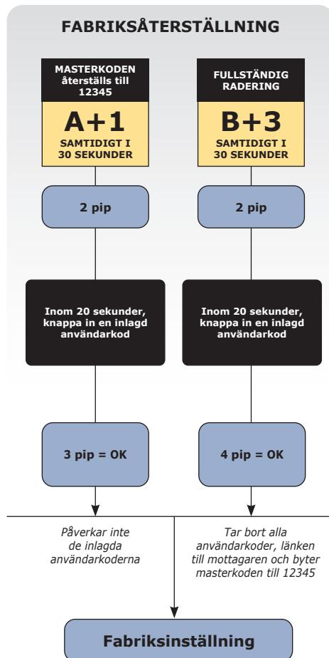
NOTERA : Vid slutet av "B+3" raderas även användarkoderna och kodlåset måste memoreras in till mottagaren igen.
